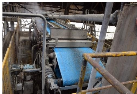
Sludge press Andritz Model: ANDRITZ CPF M 1200
